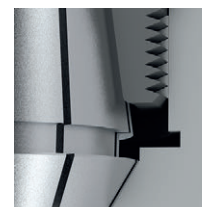
Portapinzas ER estándar, pinza portapieza no insertada al 100 % en el portapinzas.
