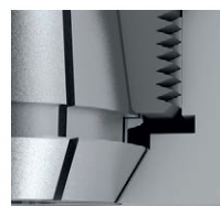
Pinza portapieza HiRunER insertada completamente en el portapinzas; ¡mayores fuerzas de retención y concentricidad mejorada!
