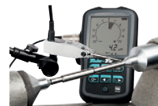
TESA μFinder Set n.º 434718 tam. 31 para mediciones de paralelismo y rectitud, así como para la alineación de máquinas.
