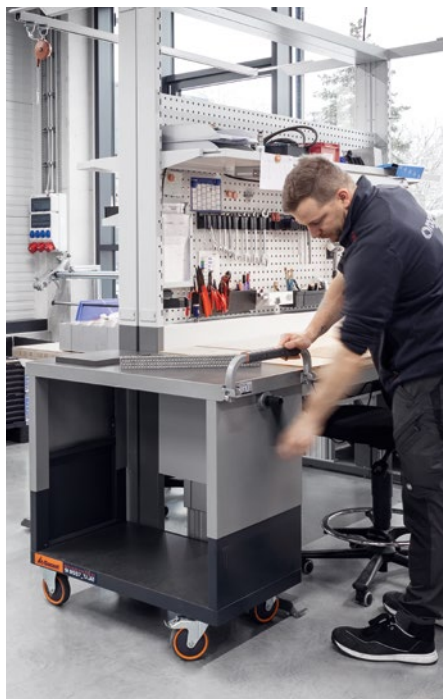
Ejemplo de aplicación: superficie de carga superior a la misma altura que el tablero de trabajo, de modo que un aparato pesado se puede desplazar fácilmente de una mesa a la mesa rodante.
