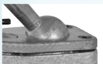
Posición de trabajo muy favorable mediante articulación esférica y corona giratoria.
